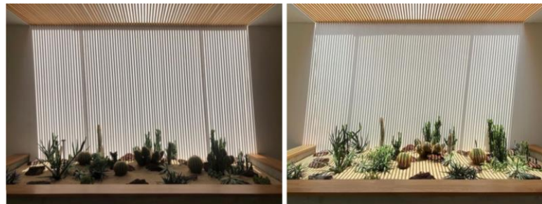
Gambar 2 Aplikasi Desain Kisi-Kisi Skylight untuk menciptakan bayangan yang berbeda sesuai dengan waktu, sebagai stimuli untuk memperkuat impresi waktu kini (Hikari House, Pranala Associates, 2021)
