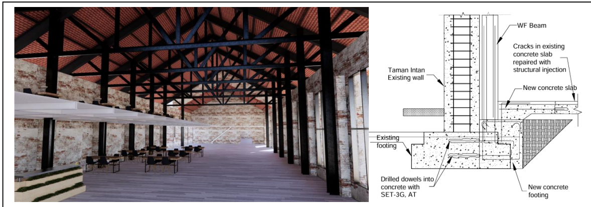
Gambar 9. Penerapan struktur kesesuaian & pondasi retrofitting di bangunan Cagar Budaya Taman Kota Intan (Dokumen pribadi, 2025)
